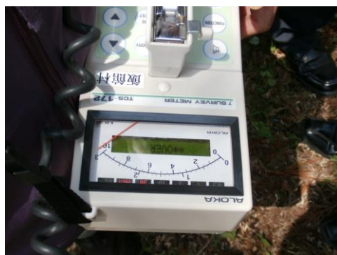
原発から50キロも離れている飯館村で、放射線量を測定すると、今も0.4マイクロシーベルトと、空間も高い数値です。側溝ではかると、30マイクロシーベルトを超えて、針は振り切っていました。
